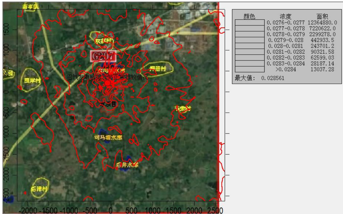
图 5.2-21 敏感点和最大落地浓度点 NO 2 1h 预测浓度（叠加背景值）
